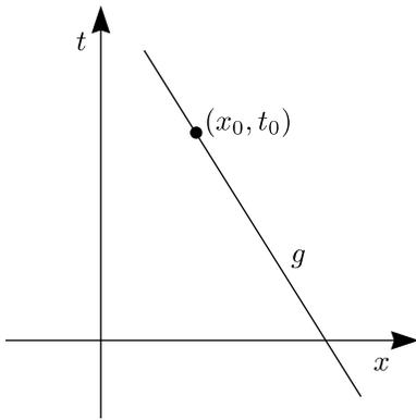
$$\vec{y}(s) = \begin{pmatrix} x_0 \\ t_0 \end{pmatrix} + s \begin{pmatrix} -c \\ 1 \end{pmatrix}$$
