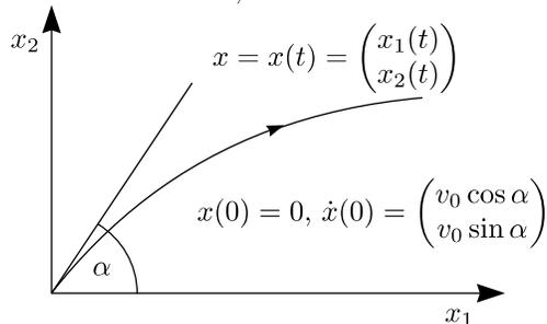
$$\mathcal{L}(t, x_1, x_2, \dot{x}_1, \dot{x}_2) = \frac{1}{2}m(\dot{x}_1^2 + \dot{x}_2^2) - mgx_2$$
