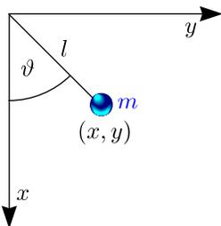
Hier ist  $n = 1$  und  $N = 1$ . Damit gilt  $x(t) = l \cos \vartheta(t)$  und  $y(t) = l \sin \vartheta(t)$ , womit wir  $\tilde{T}(\vartheta, \dot{\vartheta}) = l^2 \dot{\vartheta}^2 \frac{m}{2}$  erhalten.
