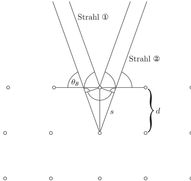
Der Gangunterschied zwischen den beiden an benachbarten Netzebenen (mit Abstand  $d_{hkl}$ ) reflektierten Strahlen beträgt  $\delta = 2s = 2d_{hkl} \sin \theta_B$ . Damit konstruktive Interferenz stattfindet, muss dies ein ganzzahliges Vielfache der Wellenlänge sein:
