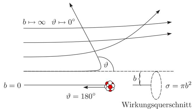
Die Rutherford-Streufelmele berücksichtigt nur das elektromagnetische Coulomb-Potential des Kerns, vernachlässigt jedoch quantenmechanische Effekte, wie beispielsweise solche der Kernphysik. Diese werden wichtig, wenn das  $\alpha$ -Teilchen dem Kern sehr nahe kommt, was auch aus folgendem Bild klar wird:
